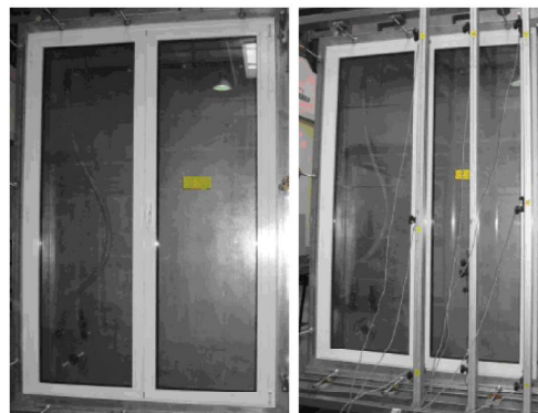
Foto 1 e Foto 2. Campione sottoposto a prova nell'assetto sperimentale e durante i test di resistenza al vento (prova di deformazione)
